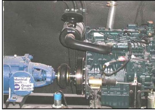
Figura 14. Detalle del acoplamiento entre bomba y motor.
