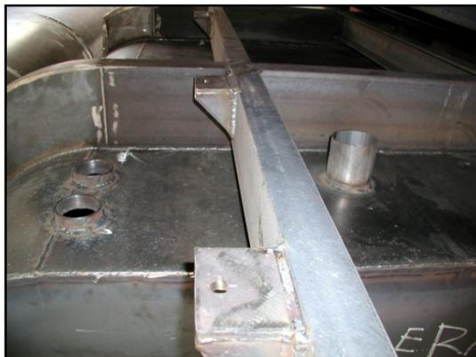
Figura 3. Vista falso bastidor y durmientes
