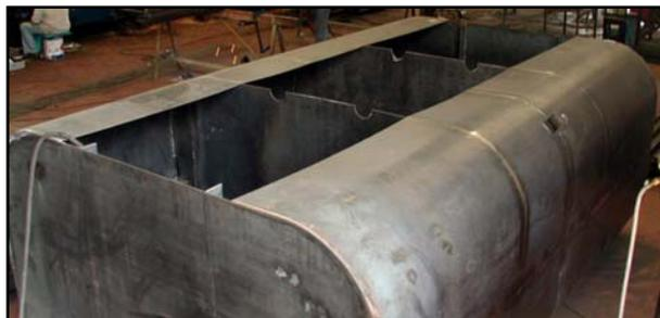
Figura 2. Montaje paredes del tanque
