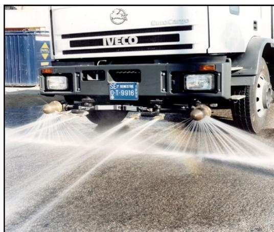
Figura 22. Boquillas baldeadoras y piñas de riego
