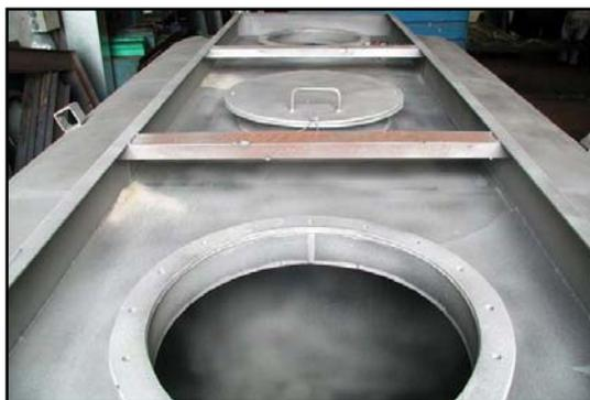
Figura 4. Detalle de las bocas de paso de hombre.
