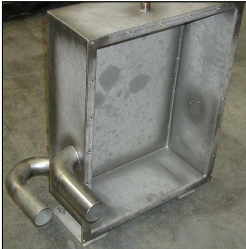
Figura 18. Carcasa del intercambiador.
