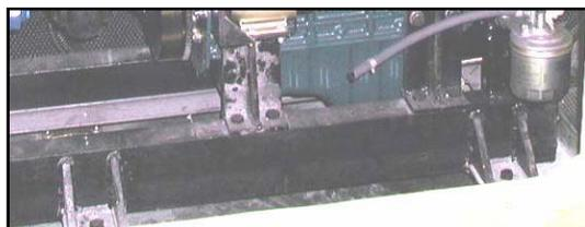
Figura 16. Unión del motor a la bancada y de los rigidizadores de unión al armario.
