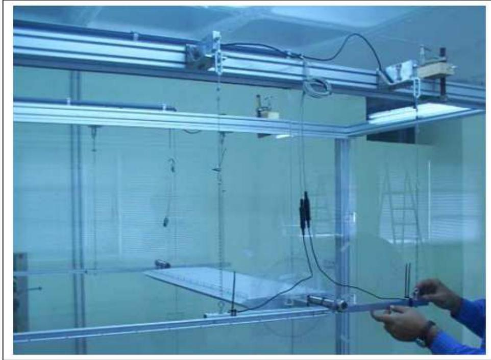
Figura 2.5.6 Modelo seccional del Great-Belt preparado para realizar un ensayo aeroelástico
