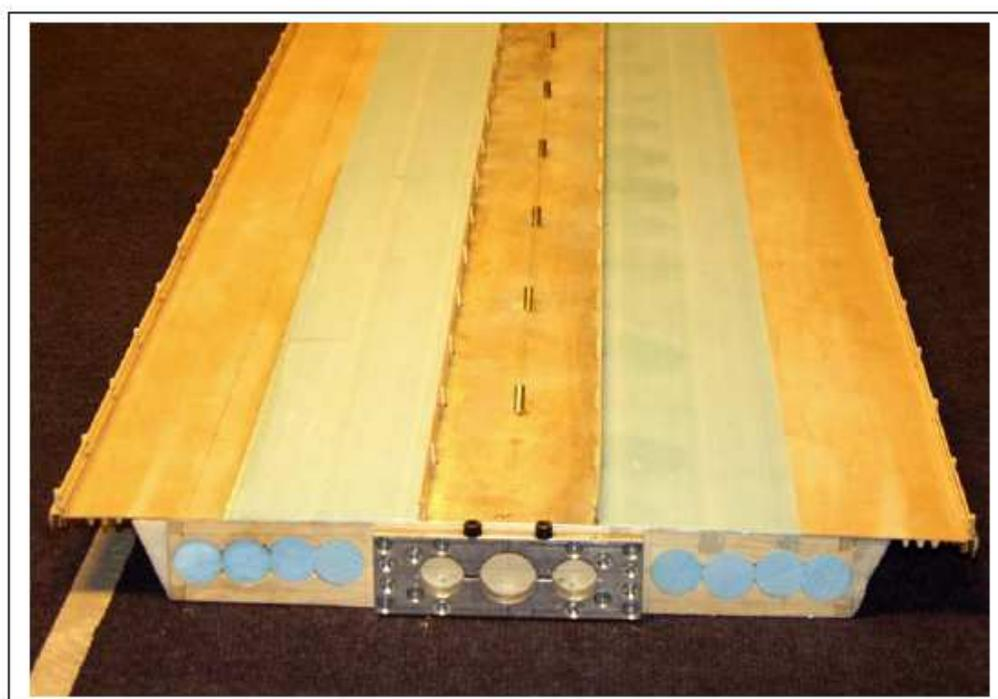
Figura 2.5.2 Detalle del modelo seccional del puente Hong Kong-Shenzhen Western Corridor.
