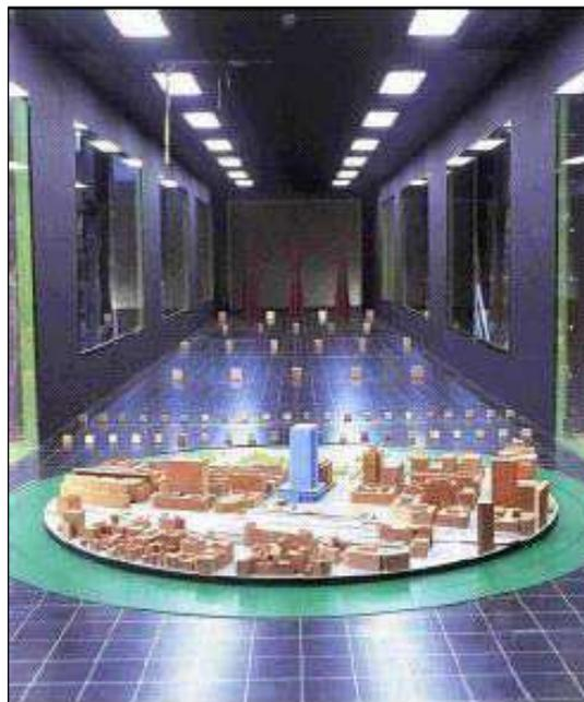
Figura 2.4.2. Modelo de un núcleo urbano para ensayo en túnel aerodinámico
