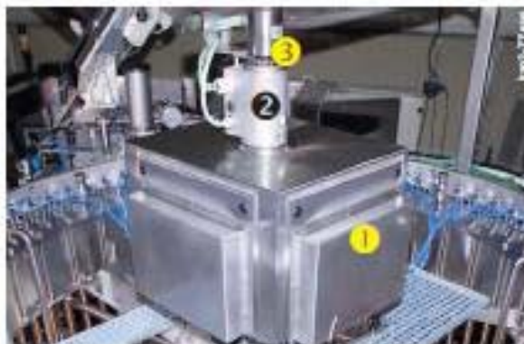
Figura 17 Mando de las válvulas de llenado
