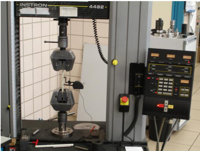
Fig. 3.12: Ensayo de tracción de barras de GFRP
