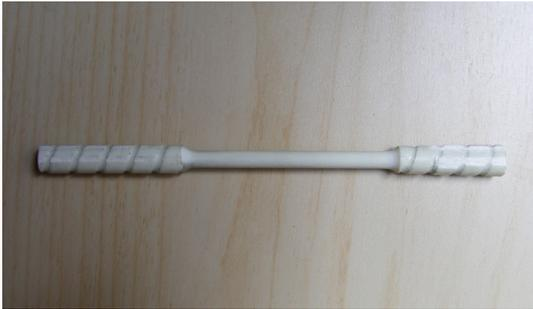
Fig. 3.13: Barra de GFRP mecanizada
