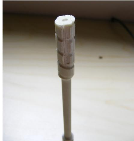
Fig. 3.14: Rotura transversal de la barra
