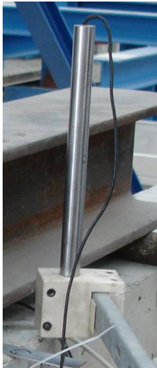
Fig. 3.16: Transductor de desplazamiento tipo LVDT
