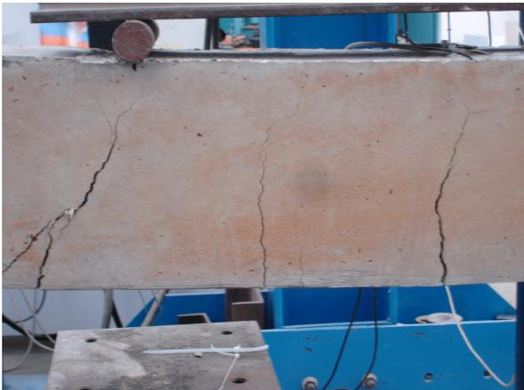
Fig. 4.22: Viga rotura de armadura
