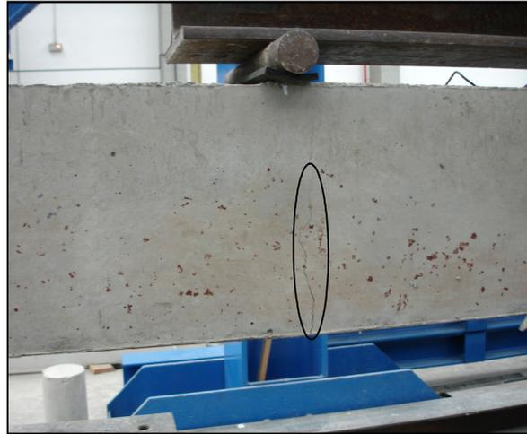
Fig. 4.13: Fisura puntos de carga
