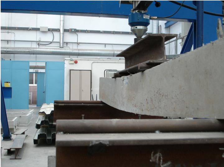
Fig. 4.7: Flecha de la viga durante el ensayo
