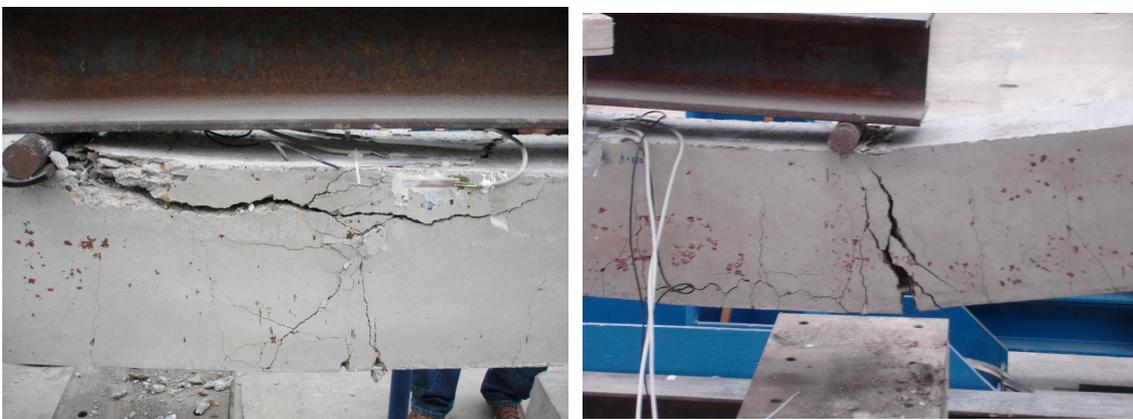
Fig. 4.31: Fallo por compresión del hormigón Fig. 4.29: Rotura del refuerzo
