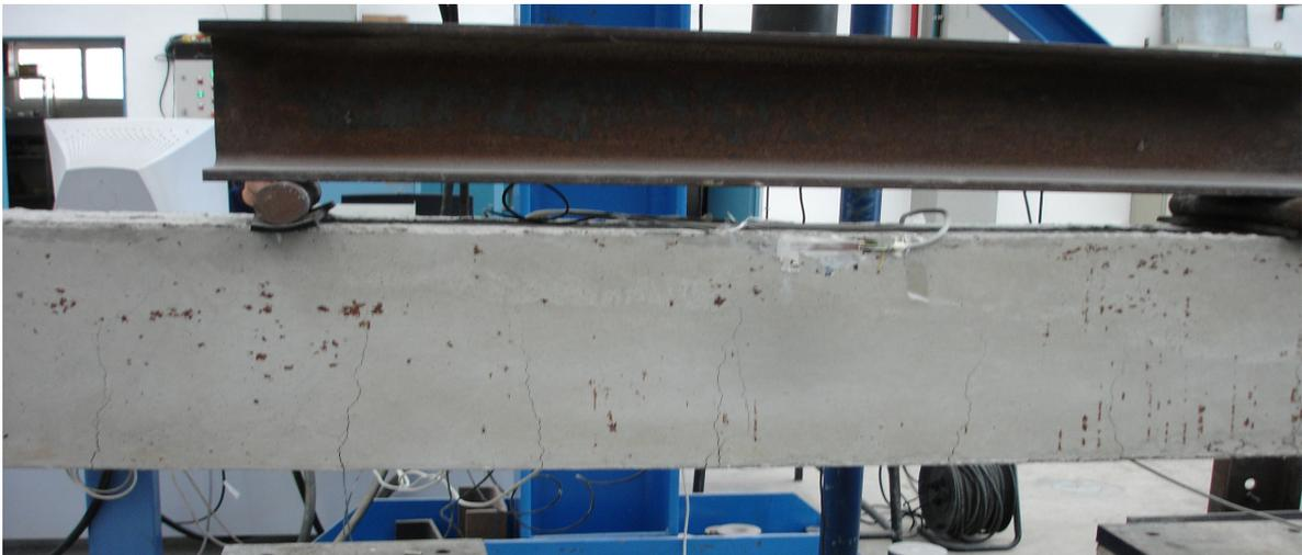
Fig. 4.14: Aparición de nuevas fisuras separadas regularmente
