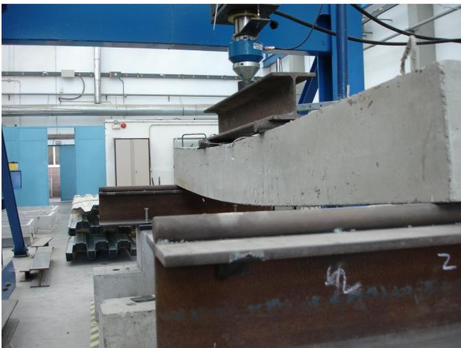
Fig. 4.3: flecha de la viga
