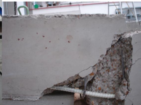
Fig. 4.35: Rotura por cortante a 45°
