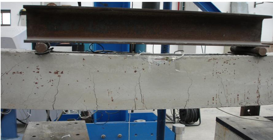
Fig. 4.15: Estabilización de la altura de las fisuras
