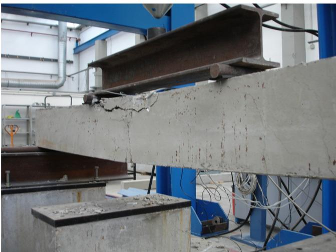
Fig. 4.4: Flecha después de fallar
