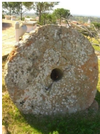
Figura 3.8. Piedra volandera original, ubicada en la zona exterior del molino.
