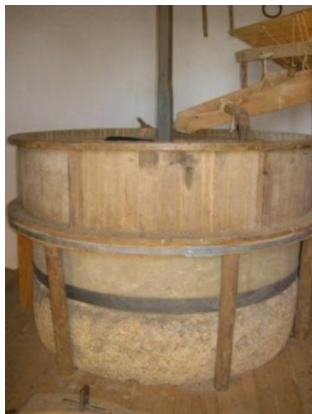
Figura 3.7. Piedra volandera y solera sobre bancada.
