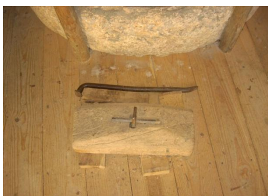
Figura 3.15. Mecanismo de freno en el piso superior.
