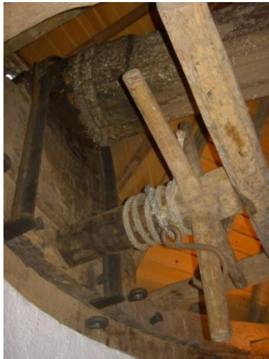
Figura 3.31. Apoyo del eje sobre el gollete.
