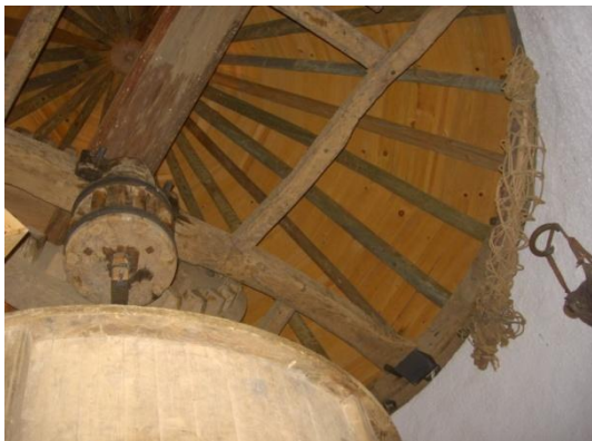
Figura 3.23. Ingenio, es todo el mecanismo que gira con la rueda grande.
