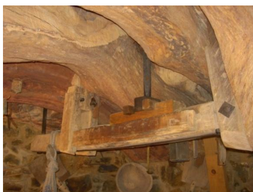
Figura 3.16. Mecanismo de freno en el piso inferior.
