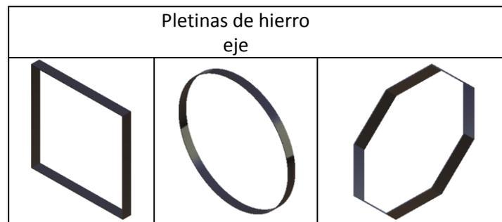
El eje lo diseñamos según las distintas secciones que presenta, como podemos apreciar en la imagen anterior, y le añadimos las pletinas de hierro, que no son más que los refuerzos en la zonas de encastre de las berlingas y en zonas próximas a sus apoyos para la protección del eje durante su giro.
