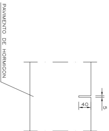
JUNTA DE RETRACCIONADO TIPO-3
