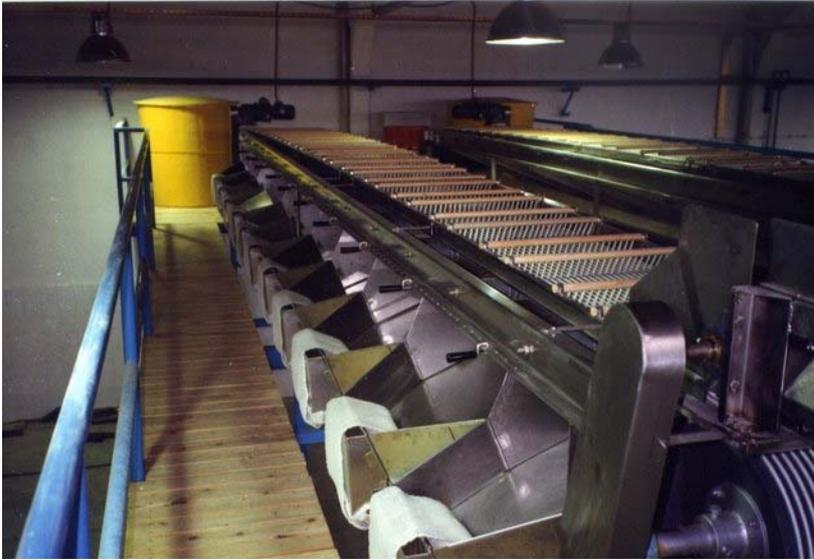
Figura 6. Calibradora automática
