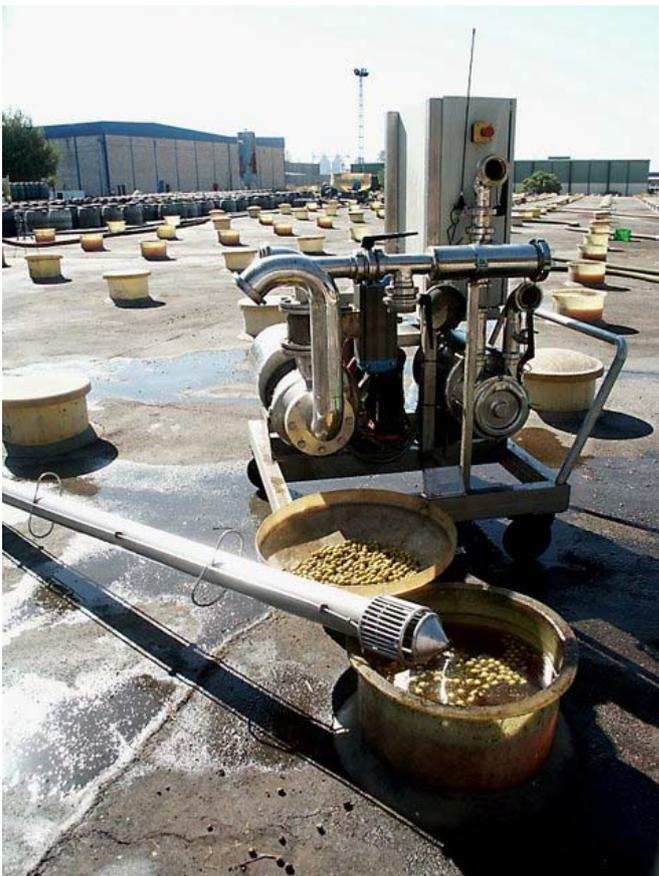
Figura 21. Bomba móvil para trasiego de aceituna en patio de fermentadores
