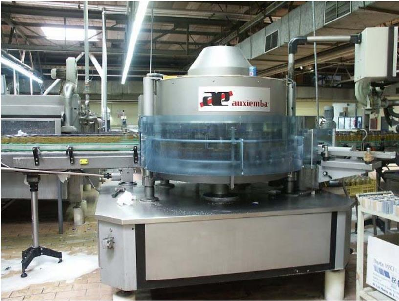
Figura 16. Etiquetadora automática
