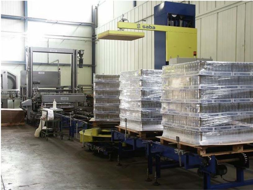
Figura 18. Paletizadora automática y envolvedora de palets
