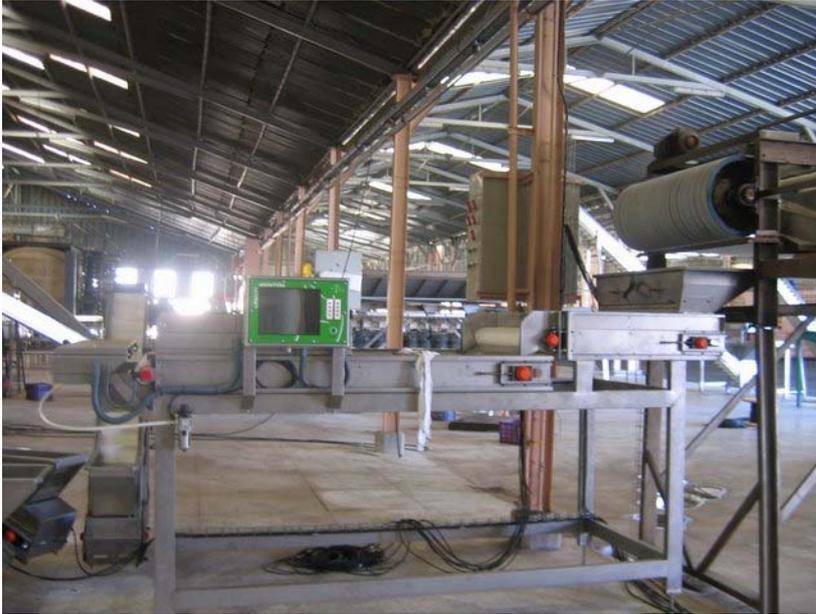
Figura 1. Selectora automática SC-348
