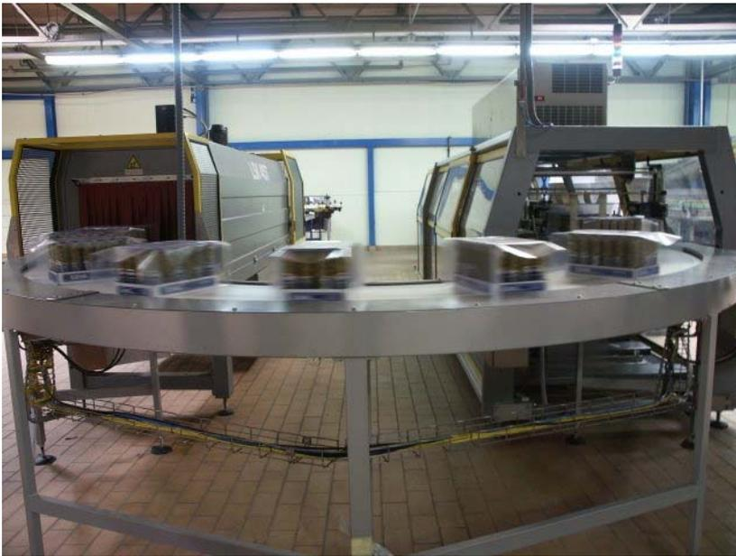
Figura 17. Formadora de bandejas y tunel retráctil
