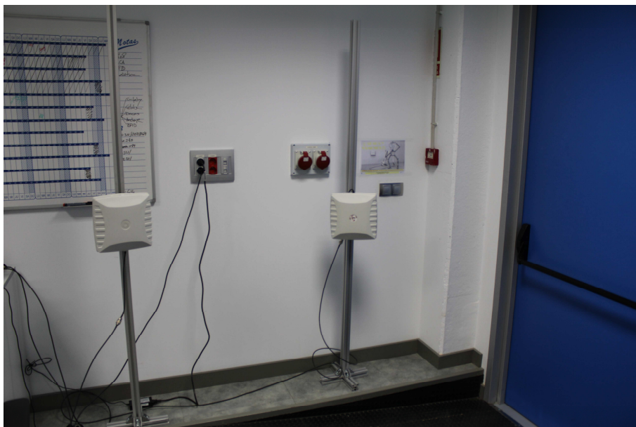
Figura 44.- Localización implantación antenas
