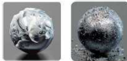
Figura 6.5: Rodamientos dañados. Fuente SKF
