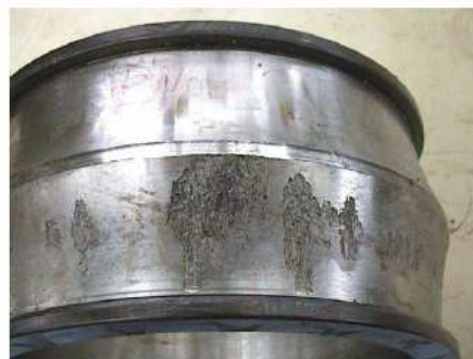
Figura 6.3: Fallo por fatiga. Turbina 600 kW, 33000 horas de funcionamiento. Fuente SKF
