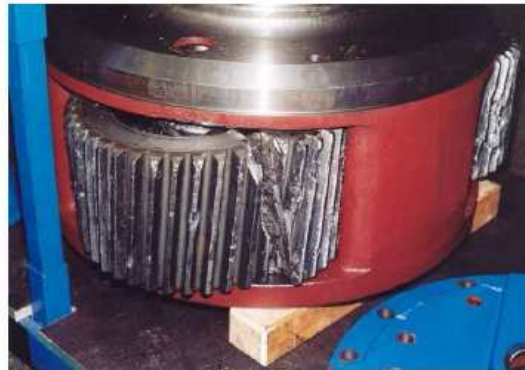
Figura 6.4: Fallo rodamientos multiplicadora. Turbina 1 MW, 20000 horas de funcionamiento.
