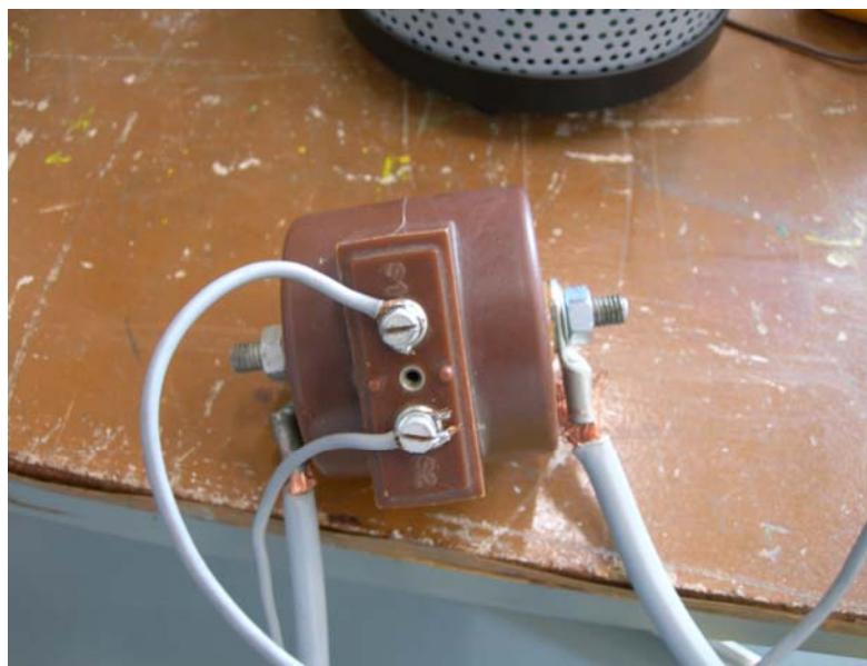
figura 7.6 Transformador de intensidad
