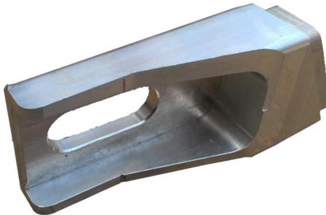
*fig. 26. Fotografía de una de las puntas del basculante.*
