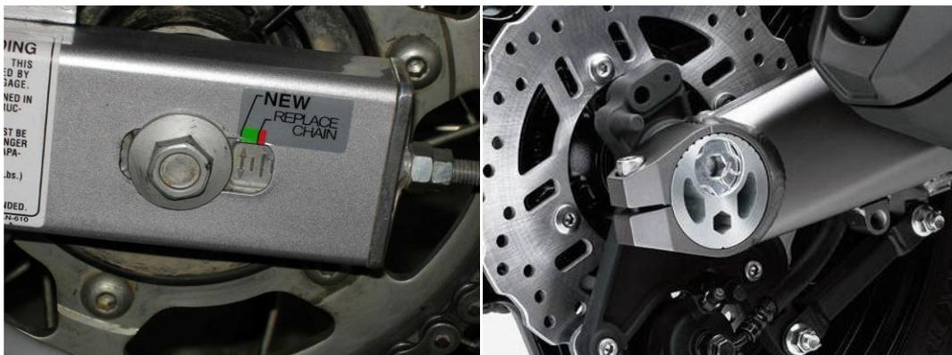
**fig. 4.a) Tensacadenas convencional (izquierda). b) Tensacadenas excéntrico (derecha)**
