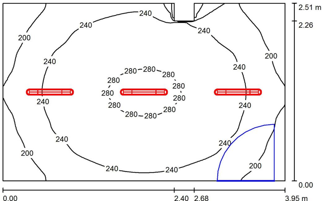
Altura del local: 2.800 m, Altura de montaje: 2.800 m, Factor mantenimiento: 0.80
