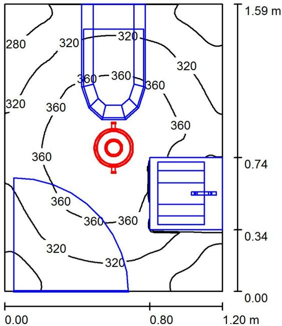
Altura del local: 2.800 m, Altura de montaje: 2.800 m, Factor mantenimiento: 0.80
