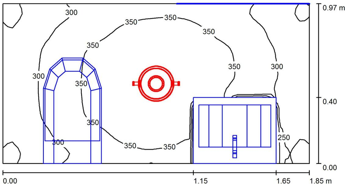
Altura del local: 2.800 m, Altura de montaje: 2.800 m, Factor mantenimiento: 0.80
