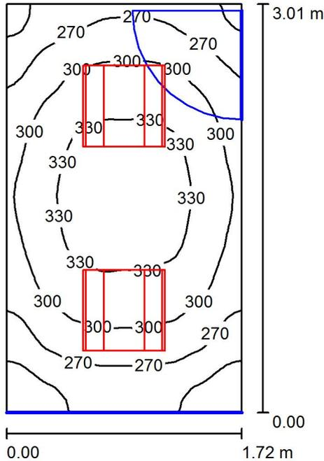
Altura del local: 2.800 m, Altura de montaje: 2.800 m, Factor mantenimiento: 0.80
