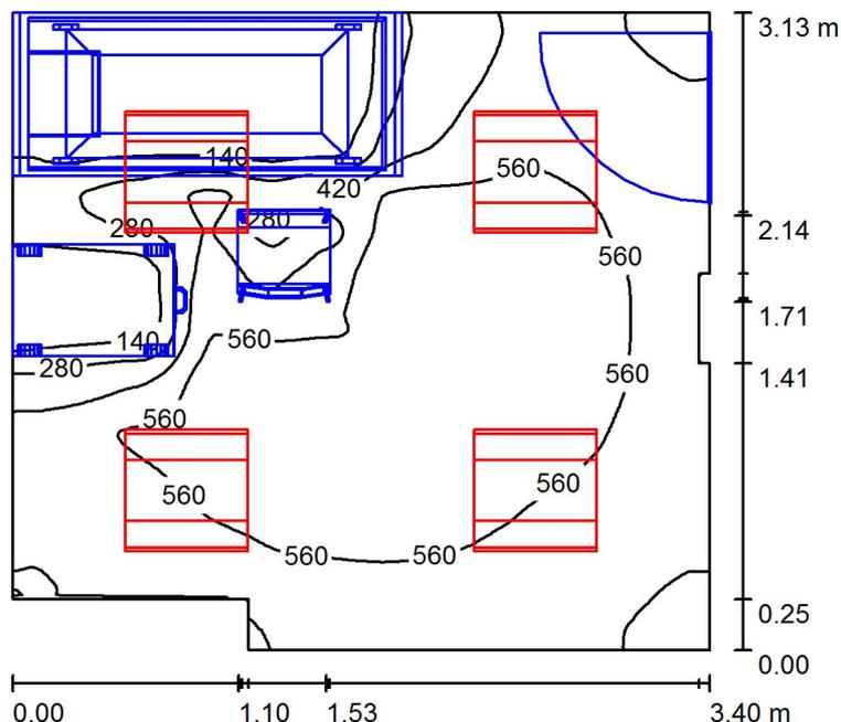
Altura del local: 2.800 m, Altura de montaje: 2.800 m, Factor mantenimiento: 0.80
