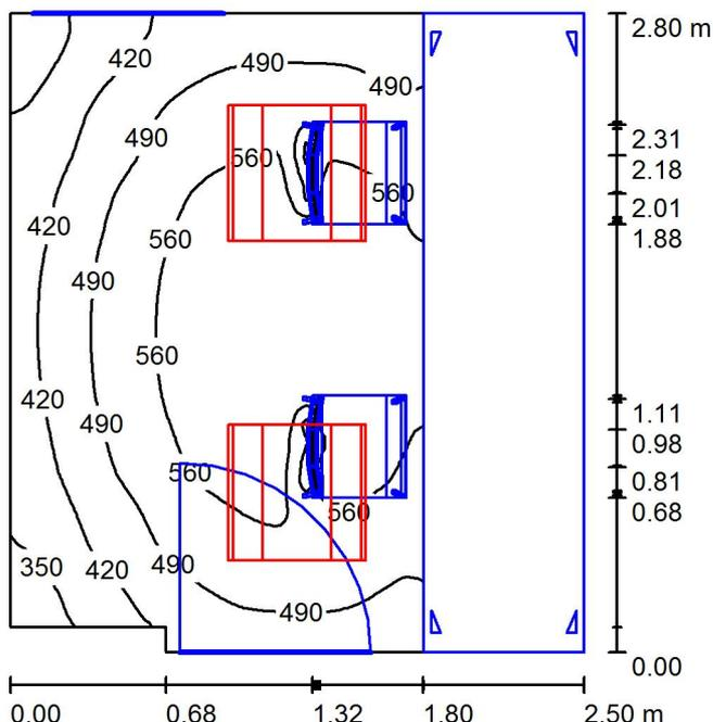
Altura del local: 2.800 m, Altura de montaje: 2.800 m, Factor mantenimiento: 0.80
