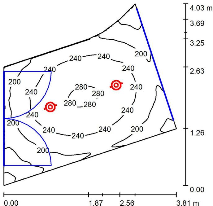
Altura del local: 2.800 m, Altura de montaje: 2.800 m, Factor mantenimiento: 0.80
