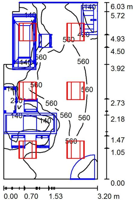
Altura del local: 2.800 m, Altura de montaje: 2.800 m, Factor mantenimiento: 0.80
