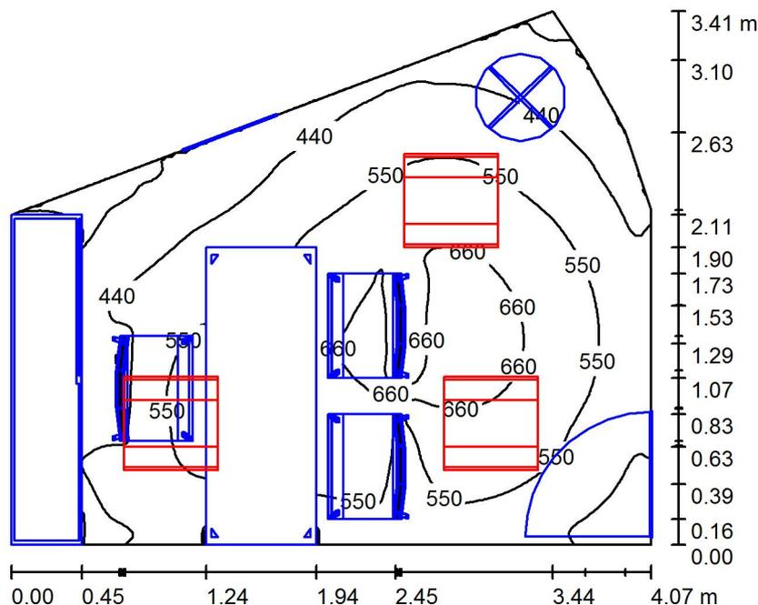
Altura del local: 2.800 m, Altura de montaje: 2.800 m, Factor mantenimiento: 0.80
