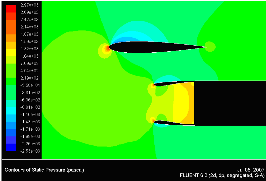
Figura 73: Presiones en el dominio fluido incompresible para u_{motor} = 85m/s y para U_{\infty} = 120m/s . Modelo bidimensional con perfil
