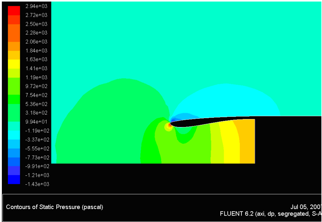
Figura 80: Presiones para u_{motor} = 70m/s y para U_{\infty} = 120m/s . Modelo axilsimétrico incompresible
