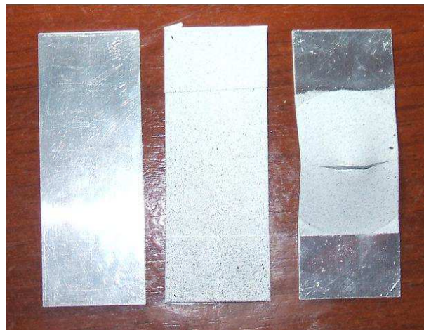
Figura 1.15: Imágenes de las probetas durante el proceso de estirado
