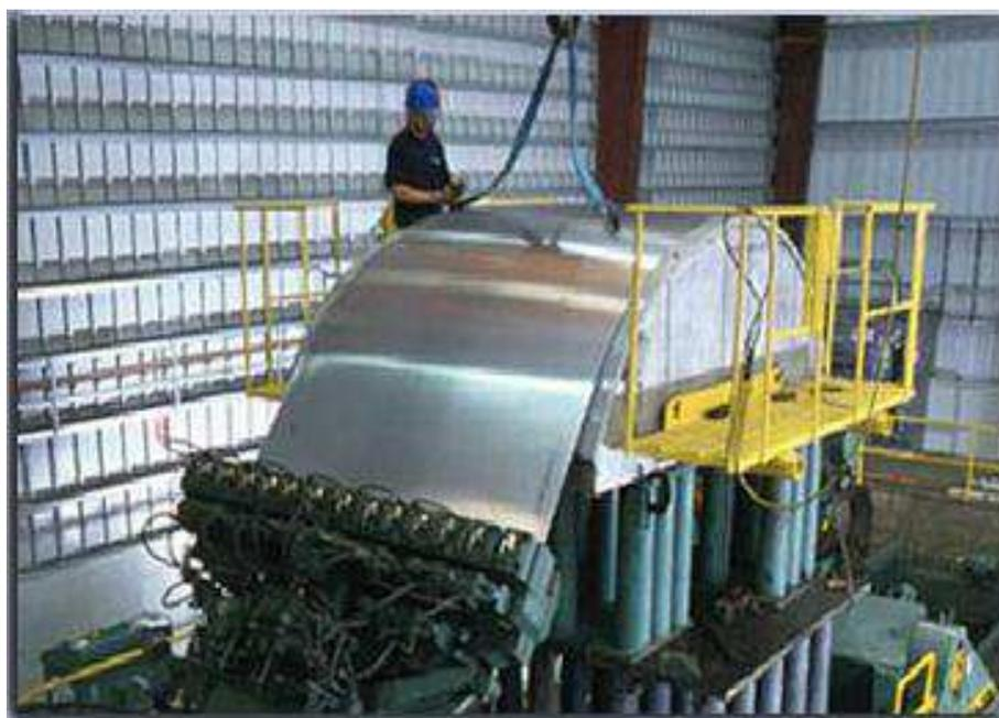
Figura 1.2: Obtención del revestimiento del fuselaje por estirado
