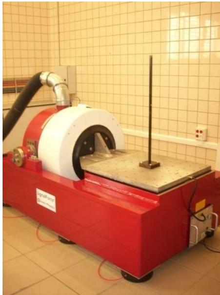
Fig. E. 3 Imagen de la disposición de la barra sobre la mesa vibrante
