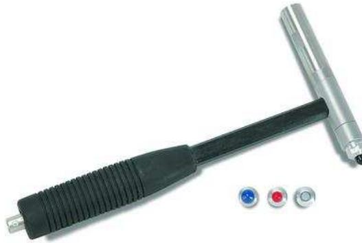
Fig. 4. 4 Imagen de un martillo instrumentado
