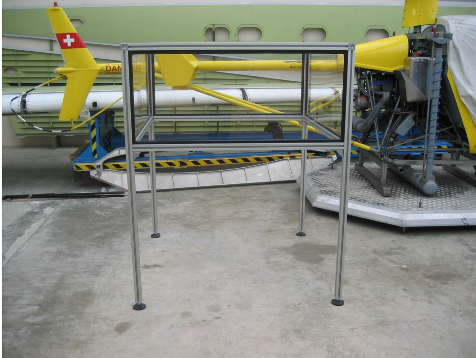
Figura 3.34: Estructura de aluminio completamente montada
