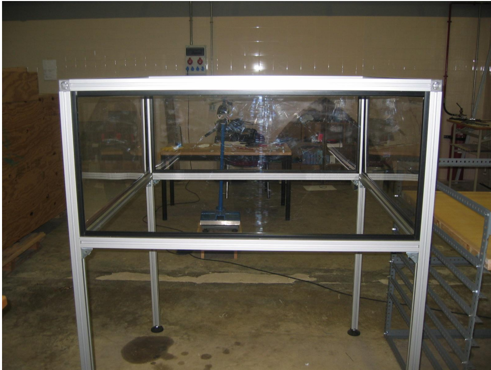
Figura 3.35: Detalle del policarbonato en el montaje final.
