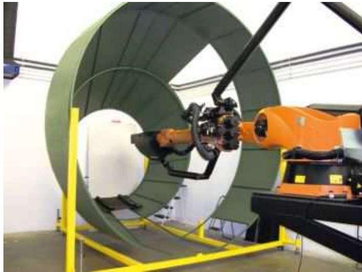
Ilustración 38. Ensayos no destructivos automáticos (cortesía de TECNATOM S.A.).
