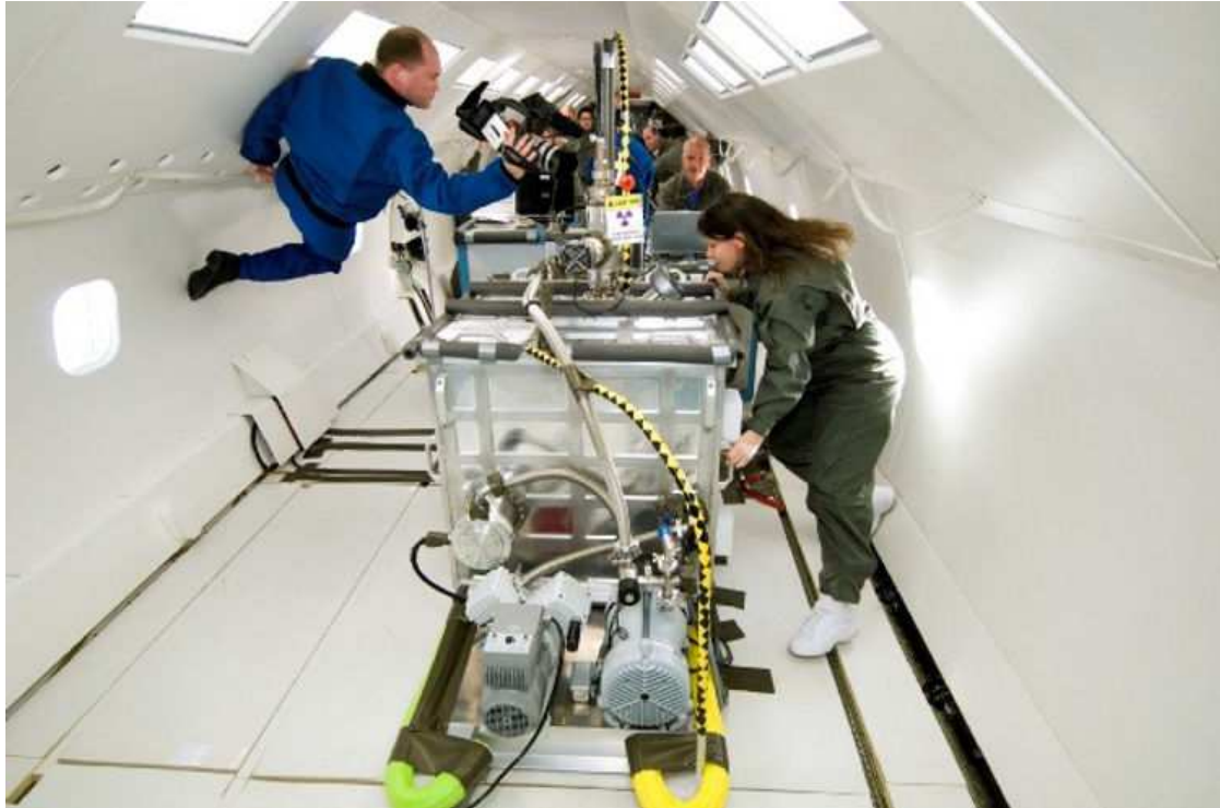
Ilustración 18. Ingenieros de la NASA probando el sistema EBM en un vuelo parabólico (cortesía NASA).
