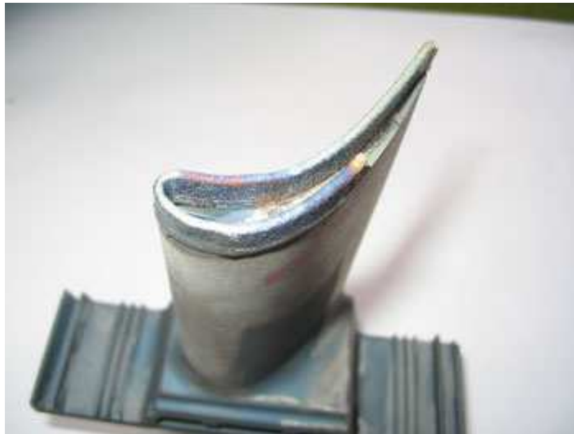
Ilustración 27. Álabes de turbina reparándose con láser cladding (cortesía de industrial-lasers.com ).
