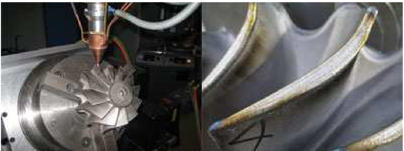
Ilustración 26. Laser cladding en la reparación de un turbocompresor (cortesía industrial-lasers.com).
