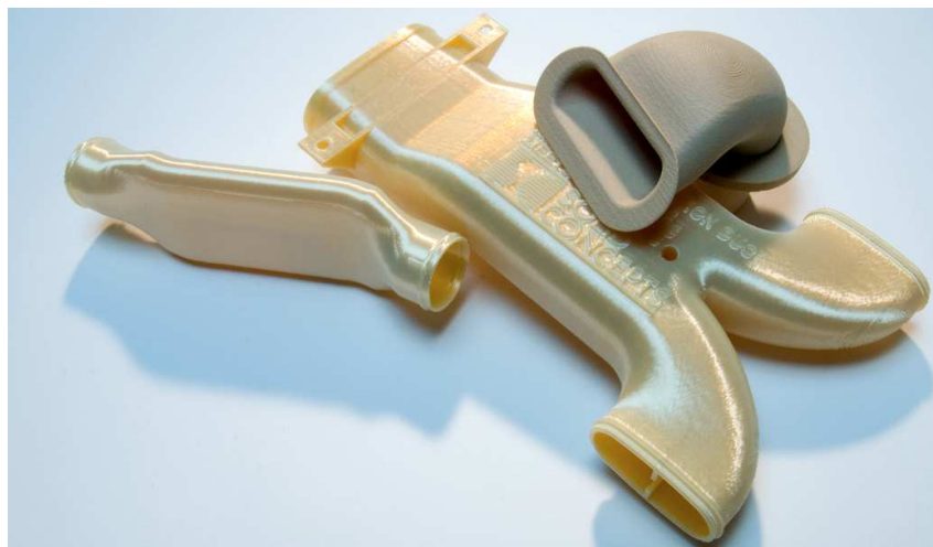
Ilustración 23. Componentes del sistema de ventilación con FDM (cortesía de Stratasys).
