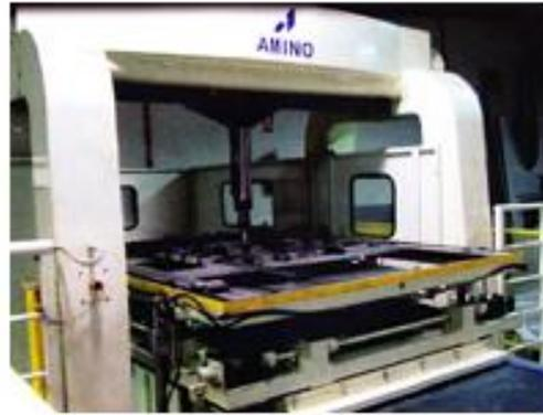
Figura 10. Máquina diseñada para procesos SPIF
