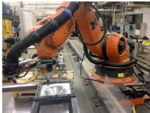
Figura 11. Brazo robótico para procesos SPIF
