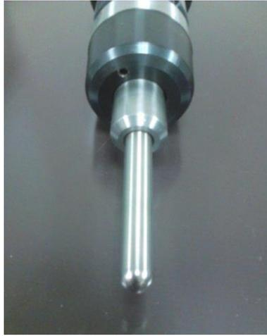
Figura 7. Herramienta de conformado incremental
