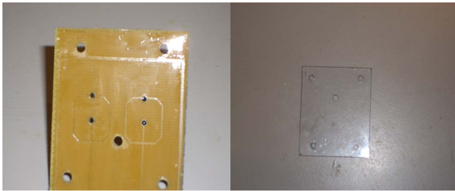
Fig.47. A la derecha microcanales del dispositivo flow focusing en SU-8 con los agujeros que alojarán a los tornillos para la unión con el PMMA. A la izquierda tapadera de PMMA con los agujeros correspondientes
