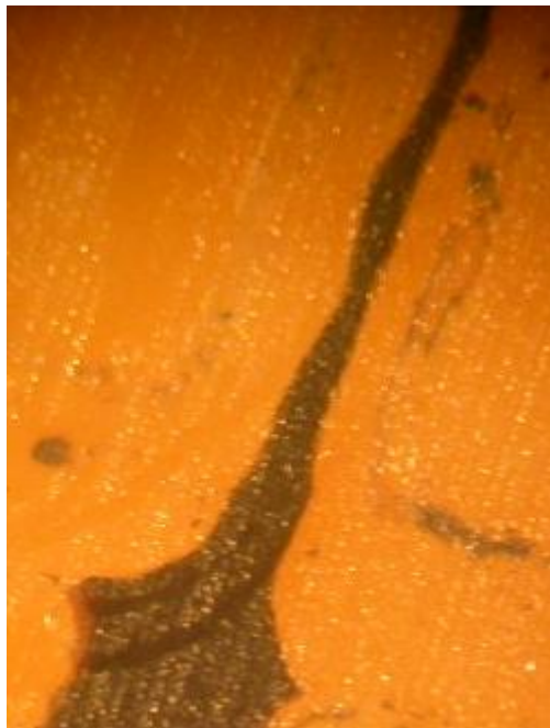
Fig.63. Desviación del chorro debido a diferencias de geometría en los canales de enfocante.
