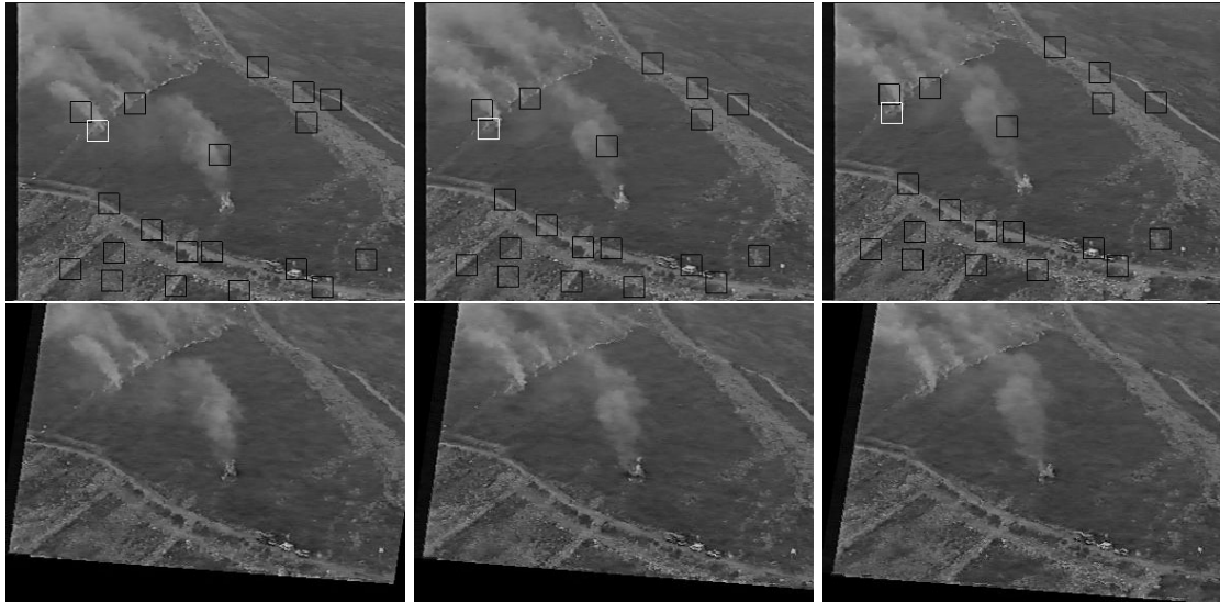
Figura 1: Estabilización. Imágenes originales e imágenes estabilizadas.
