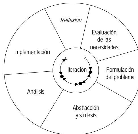
Figura 2. El proceso de diseño de ingeniería, incluyendo la tarea de Reflexión (Voland, 1999) [172].
