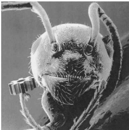
Figura 2.1: Hormiga sujetando un micro-engranaje de níquel, realizado mediante un proceso LIGA (Siglas alemanas de “lithographie, galvanofornung, abformung”). La hormiga fue metalizada y colocada en una cámara de vacío para ser fotografiada mediante un microscopio electrónico.
