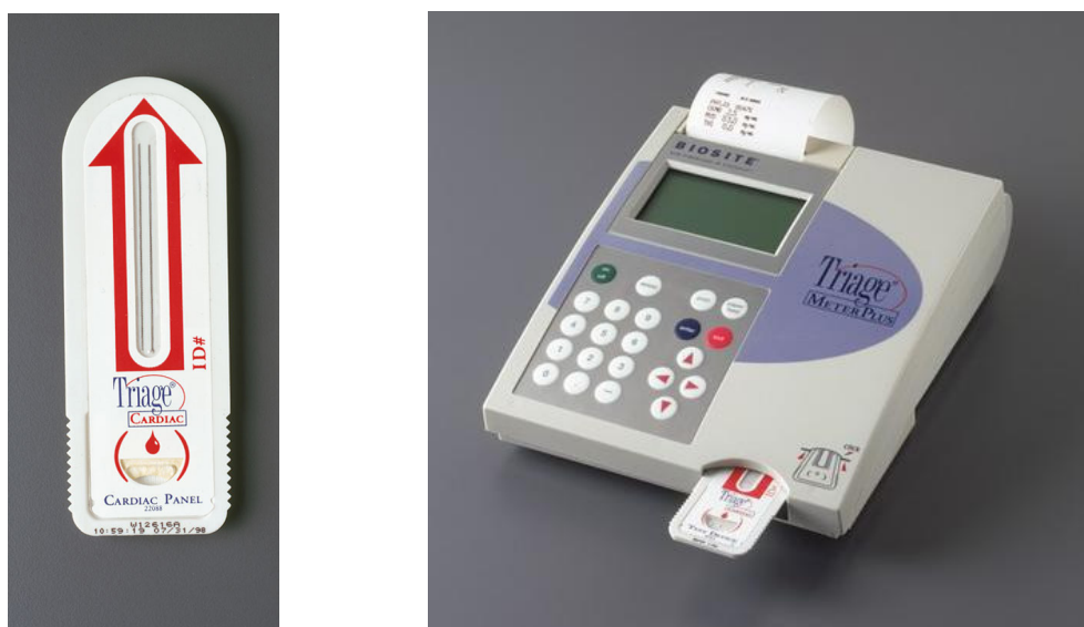
Figura 3.10: Chip Biosite junto a su sistema de adquisición de datos.
