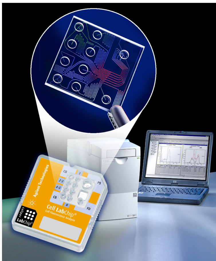
Figura 3.11: Ejemplo de dispositivo Lab-on-Chip: Agilent 2100 Bioanalyzer, que junto con su extensión para ensayos celulares, puede realizar análisis simples de citometría de flujo. El chip amarillo de la imagen tiene tan sólo unos pocos centímetros de largo.
