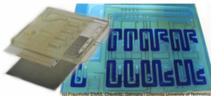
Figura 4.5: Fotografía del dispositivo fabricado. A la derecha tenemos el LOC descrito arriba y a la izquierda una implementación con 9 microválvulas integradas.
