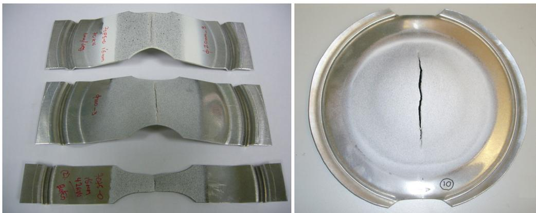
Fig. 5-3: Tipología de probetas ensayadas: tracción pura, deformación plana, zona biaxial
