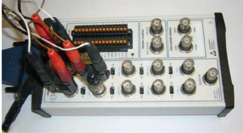
Fig. 5-10: Tarjeta de adquisición de datos
