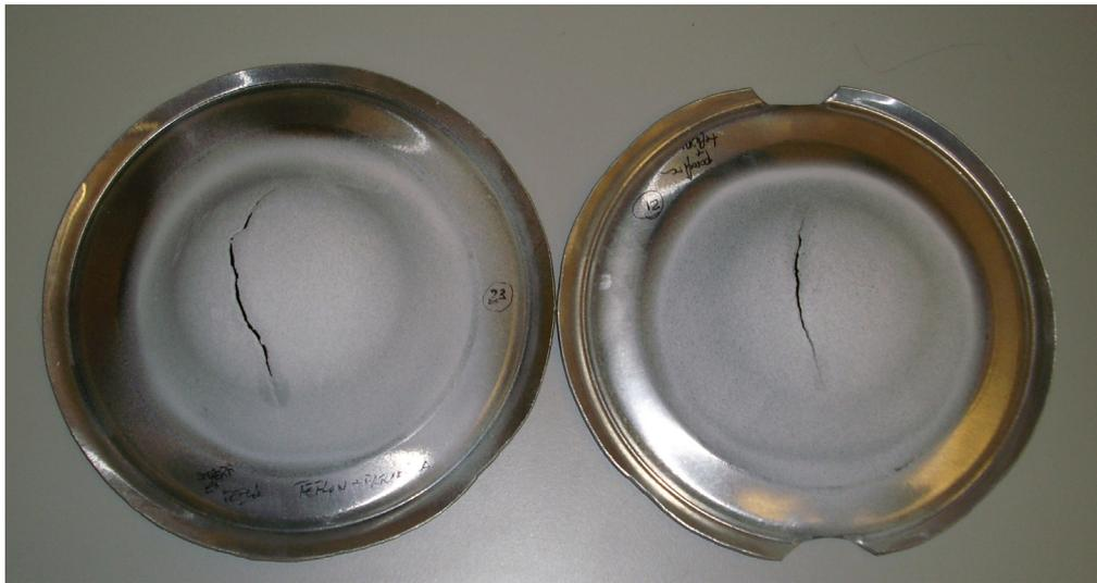
Fig 5-8: Probetas biaxiales con roturas fuera de la zona recomendada
