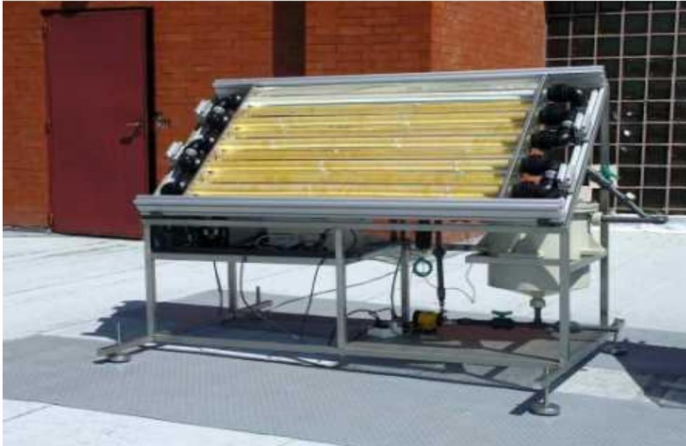
Fig. 3.4. Fotorreactor solar CPC
